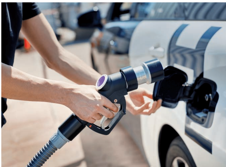
Na rozdiel od tradičného tankovania na benzínovej čerpacjej stanici treba pri tankovaní vodíka zabezpečiť veľmi presné meranie teploty a tlaku. (Zdroj: pixabay/Heinrichs Messtechnik GmbH)
