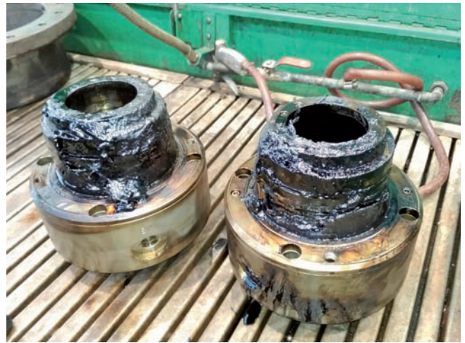
Obr. 11 Príklad znečistených mechanickej upchávok hydrodynamického čerpadla
