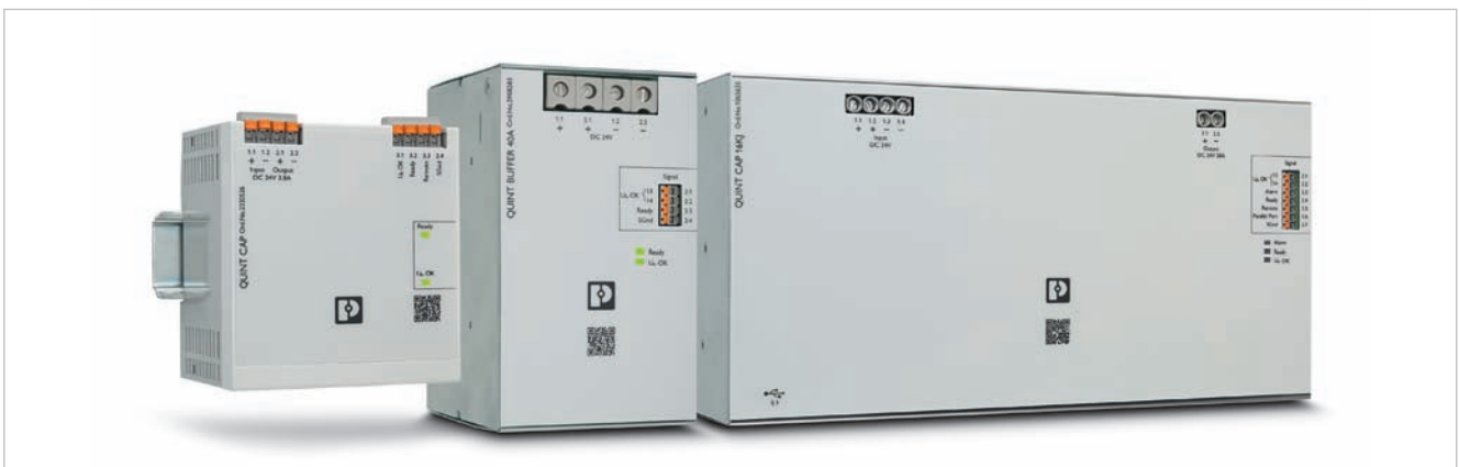
Obr. 4 Komplexný sortiment: produktový rad QUINT 4 CAP obsahuje vyrovnávacíe moduly pre rôzne aplikácie – 1 kJ (vľavo) a 16 kJ (vpravo) na báze dvojvrstvových kondenzátorov, ako aj vyrovnávací modul na báze elektrolytických kondenzátorov (v strede).
