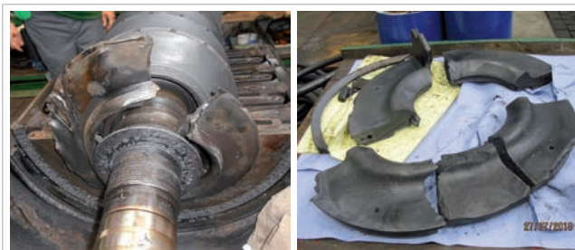
Obr. 7 Zaznamenané poškodenia na komponentoch kompresora
